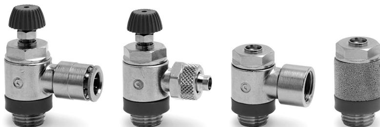
Пневмодроссели с обратным клапаном и без него регулируют скорость цилиндров и расход воздуха в пневмосистеме. Конструкция дросселей с поворотными серьгами позволяет устанавливать их непосредственно на цилиндре и легко присоединять к ним трубопровод.
