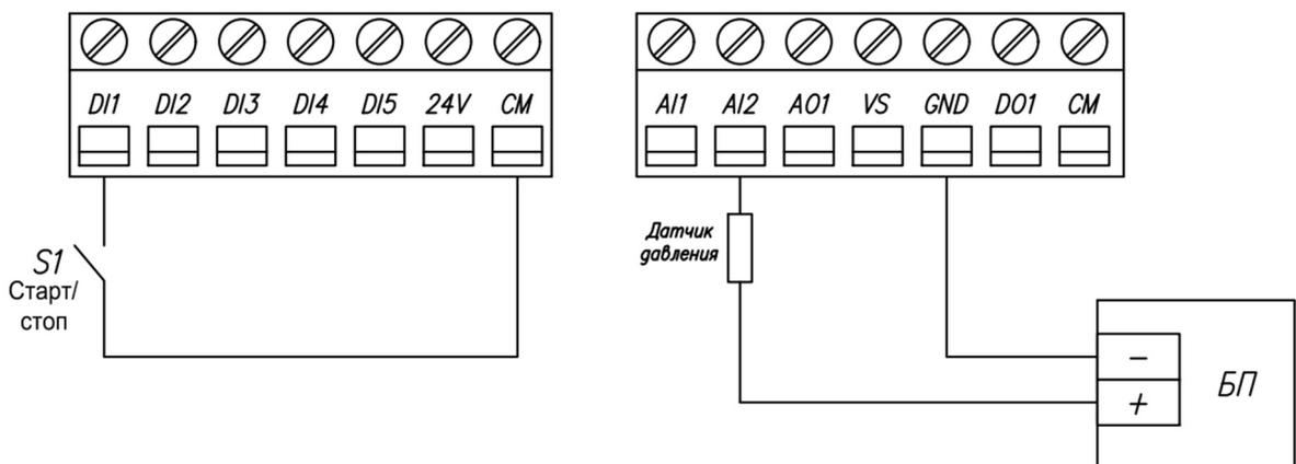
Рисунок 1. Схемы подключения датчика давления к KIPPRIBOR AFD-E.
