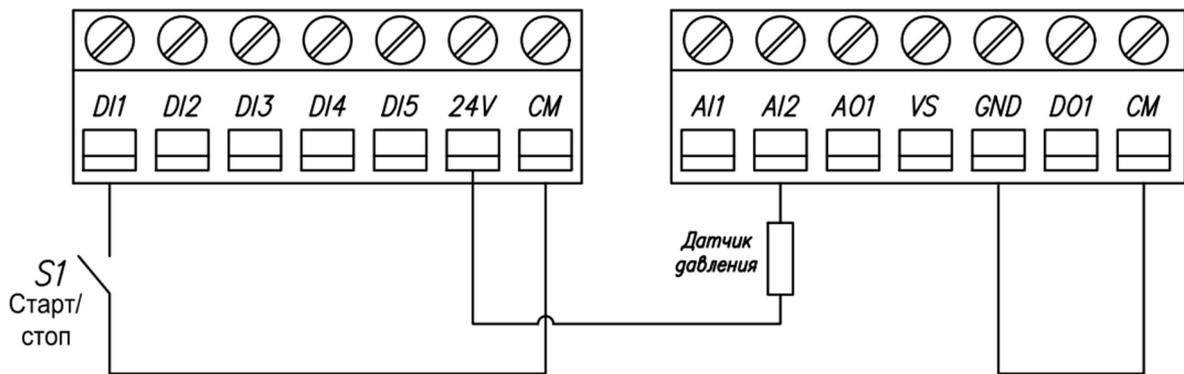
*Схема подключения датчика давления к AFD-E
