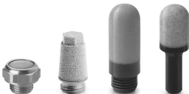
Глушители – это необходимые элементы для устранения или снижения шума во время выхлопа сжатого воздуха. Они всегда должны устанавливаться на выхлопные отверстия 3/2, 5/2 или 5/3 лин./поз. распределителей. Периодически в процессе эксплуатации глушители необходимо обезжировать уайт-спиритом и продуть через них сжатый воздух в обратном направлении.
