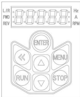
Встроенный в модуль управления CU00 пульт может использоваться для установки/считывания параметров, управления, мониторинга и т. д.
