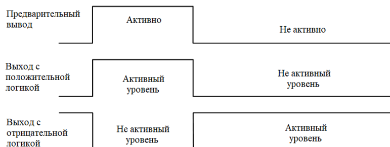
Рис. 7-14 Схематическая диаграмма положительной и отрицательной логики выхода цифрового выходного терминала
