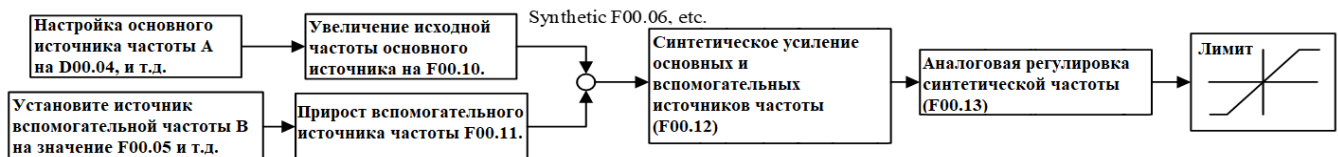
Рис. 7-8. Управление настройками источника частоты (описание усиления).
