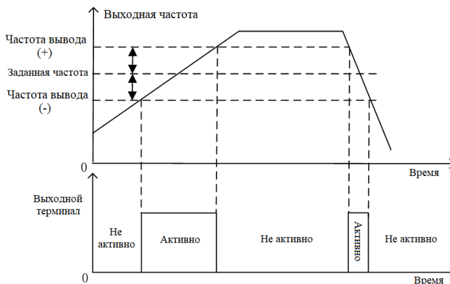
Рисунок 7-36 - Схематическая диаграмма обнаружения FA
