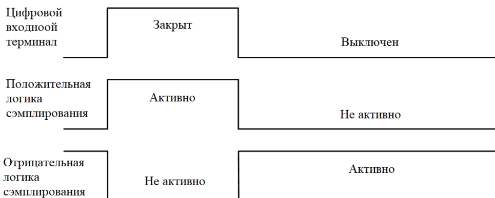
Фигура 7.12. Схематическая диаграмма с положительной/отрицательной логикой выборки с терминала.
