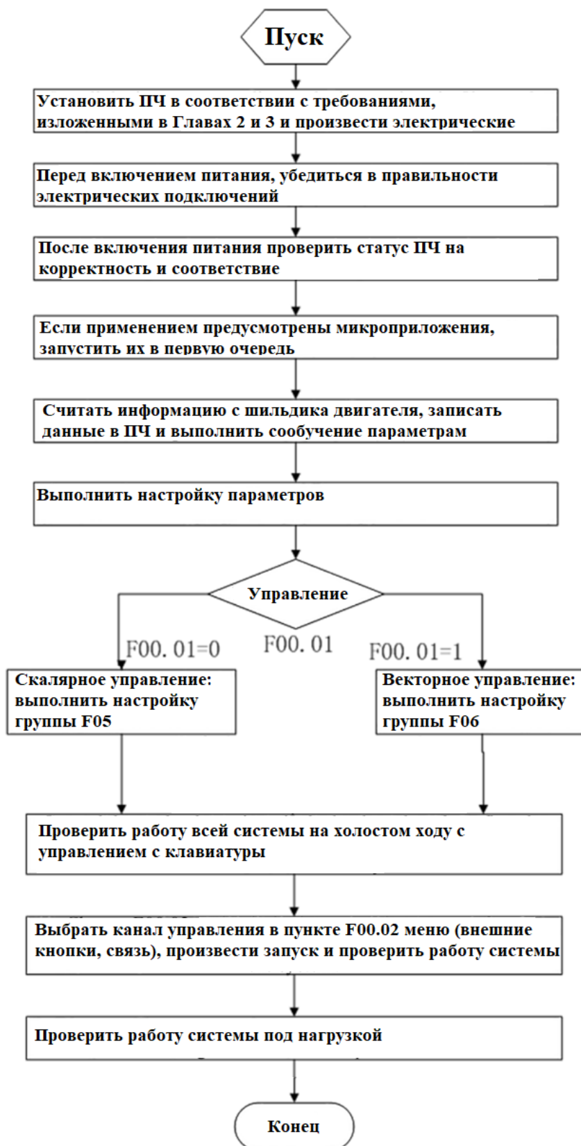
Рис. 5-1 Блок-схема процесса пуско-наладки ПЧ
