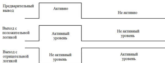
Рисунок 7-14 Диаграмма положительной и отрицательной логики выхода цифрового выходного терминала.
