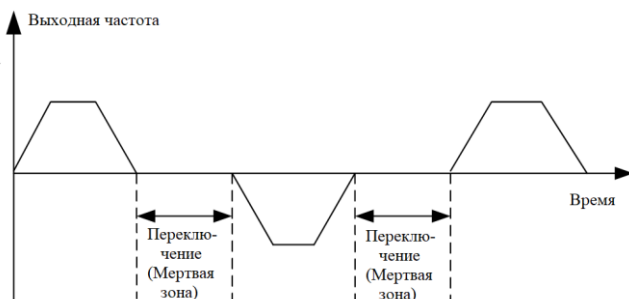
Рисунок 7-8 Временной интервал для плавного переключения между прямым и обратным вращением.
