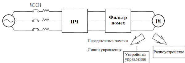
Рисунок 3-7 Установка фильтра помех на выходной стороне
