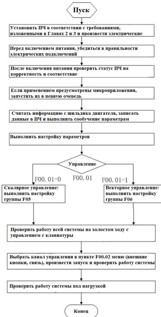
Рисунок 5-1 Схема процесса наладки частотного преобразователя
